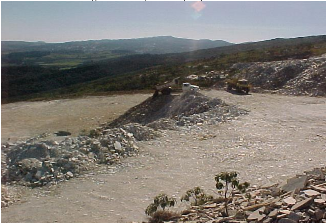
Imagem 7 – Transporte e disposição do estéril.
