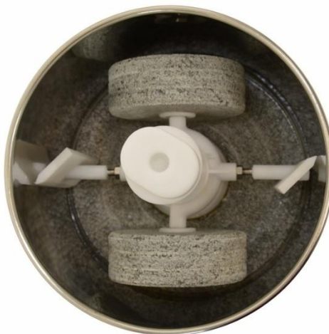
Figura 20 – Moinho de pedra ( melanger ) utilizado no processo de moagem do cacau
