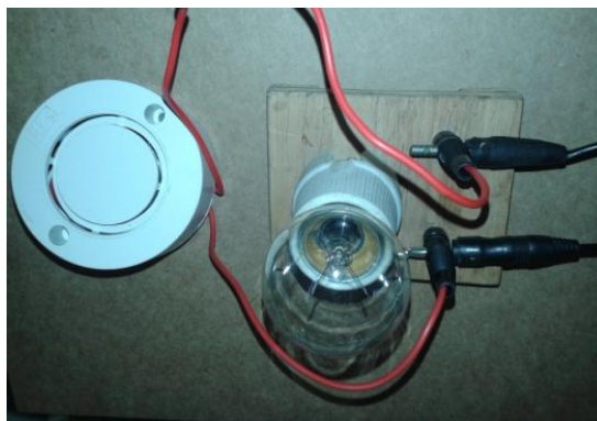
Figura 26 - Campainha de 127 V, fios de ligação e uma lâmpada de 25 W / 127 V.
