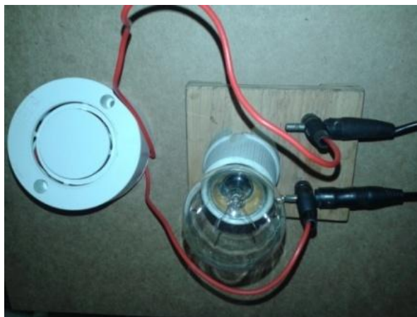
Figura 19 - Montagem que permite perceber o funcionamento do circuito através da audição.
