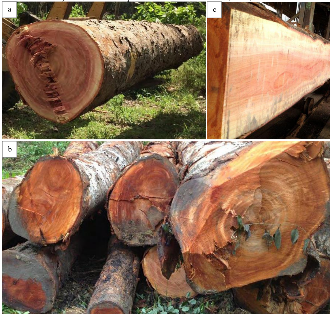
Figura 3.1 – Toras (a e b) e pranchão serrado (c) de mogno-africano ( Khaya grandifoliola C. DC.) oriundos de um plantio de 18 anos de idade, Pará, Brasil.
