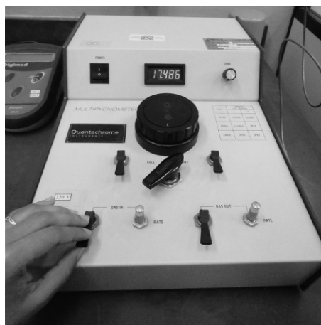
Figura 17 Aparelho utilizado na determinação da densidade real das fibras
