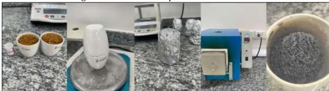
Figuras 12 – Processo de pirólise das biomassas
